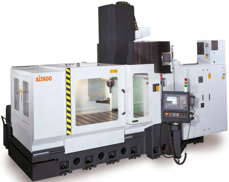
3-х координатный обрабатывающий центр с ЧПУ HS9060
