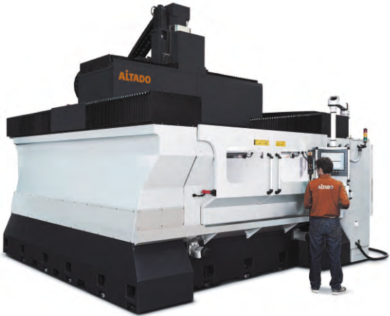
5-ти координатный обрабатывающий центр с ЧПУ M5X-2516
